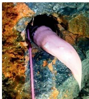
2-rasm. String Loading texnologiyasidan foydalangan holda diametri 54 mm bo'lgan shpurlar zaryadlangan, mahsulot sarfi 0,6 kg/m (chapda) va mahsulot sarfi 1,2 kg/m.
