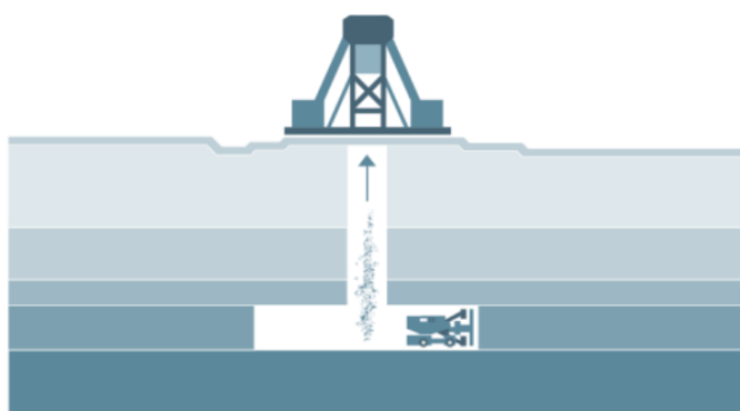
3-rasm. Kaliy rudalarini yer osti shaxtalari yordamida qazib olish. Kaliy tuzini qazib olish usullarining o'ziga xos afzallik va kamchiliklari 1-jadvalda taqqoslangan.
