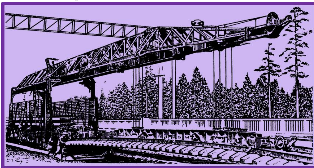
2- расм. Йўл панжарасини йўл ётқизувчи УК-25 машинаси билан қўйиш.
