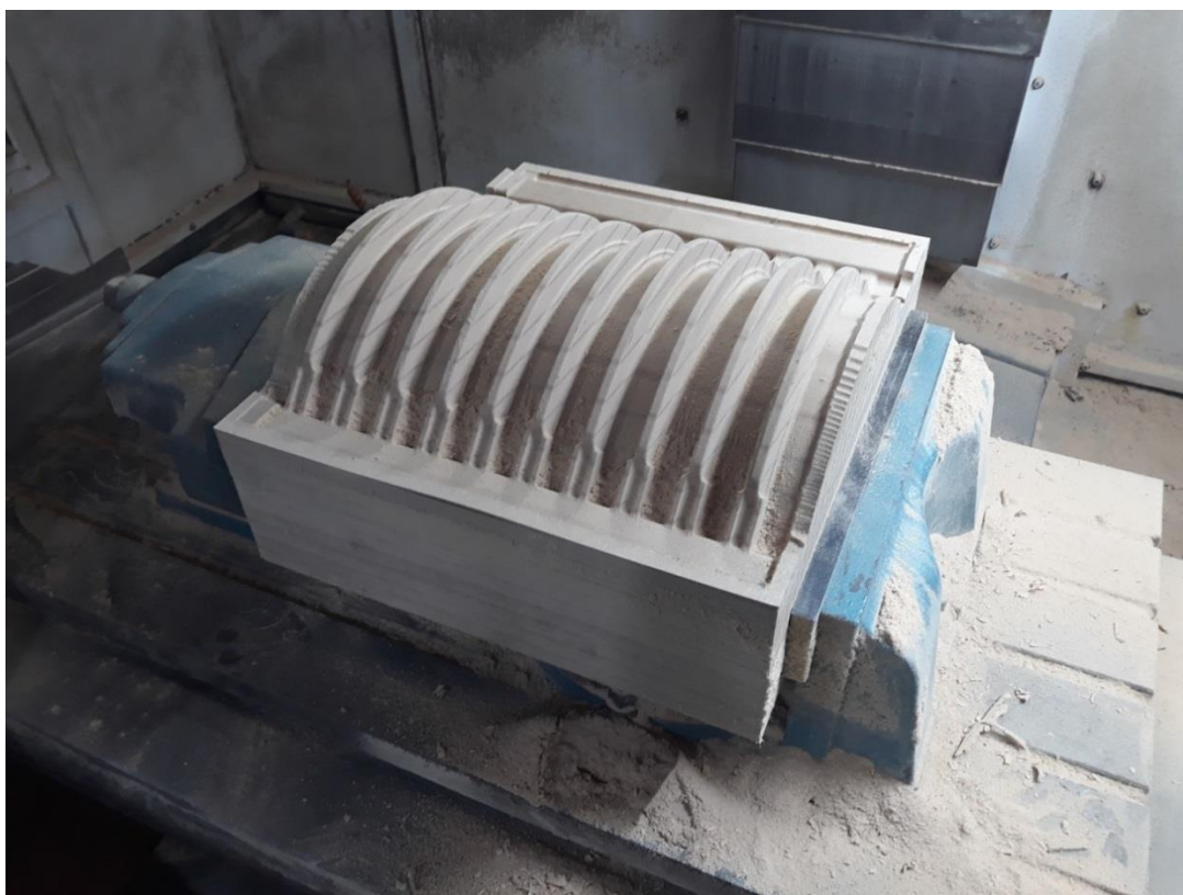
Rasm-16: DSP xom ashyosidan tayyorlash va uni raqamli dasgohda. DSP xom ashyosidan tayyorlab bo'lgandan so'ng laklab olinadi(rasm-17).
