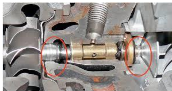
1.2-rasm. Kompresor valining yeyilishi ko'rsatilgan
