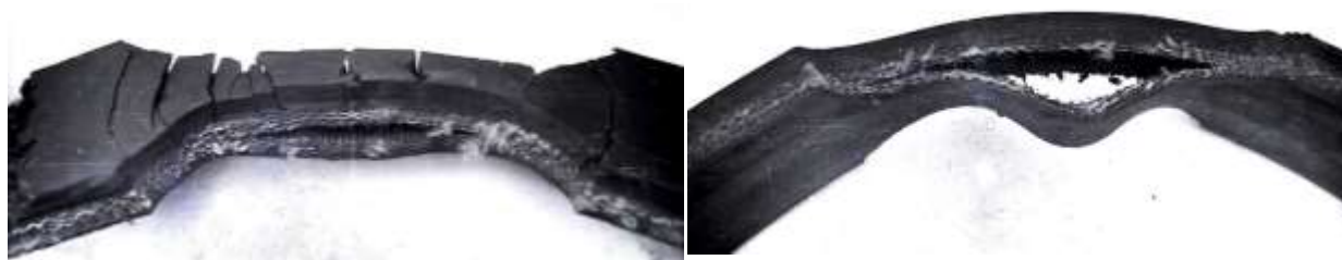
Yuqori sovuq haroratda lentalar mo'rt bo'lib ko'ndalang yoriqlarning hosil bo'lishi
