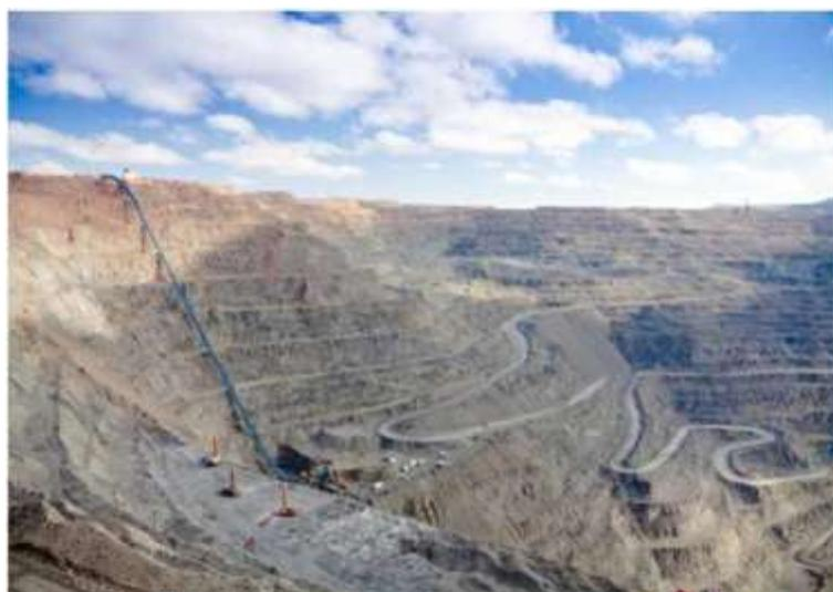
*Рис. 1 - Крутонаклонный ленточный конвейер на карьере Мурунтау*
