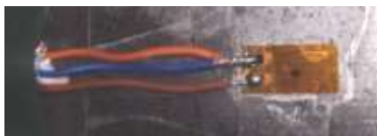
2-расм. Тензодатчикнинг ёпиштириб ўрнатилиши
