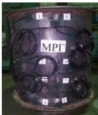
4-расм. Кучайтирилмаган силлиқ қобик МРТ намунасининг синовдан кейинги кўриниши
