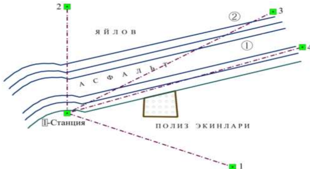
1- расм. 1-метеорологик станцияда бурчак ўлчаш асбоблари ва визирлаш марказлари жойлашган дала тажриба схемаси.
