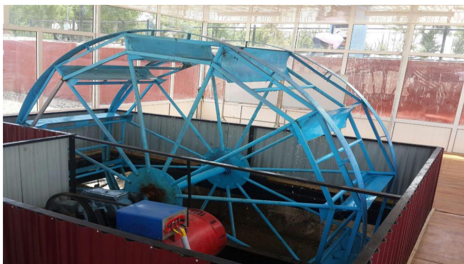
3-rasm. Mikro-GESni ishlash jaryoni.
