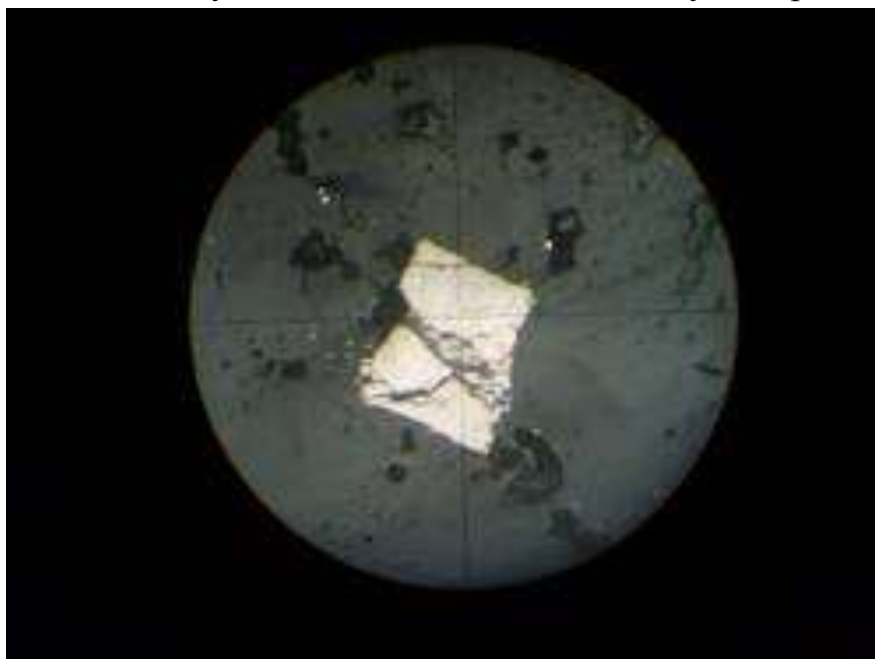
Рис-7. Аншлиф. Пирит. Почти идеальный кристалл (прямоугольной формы) разбит трещиной на две части. В хорошо изготовленном аншлифе
