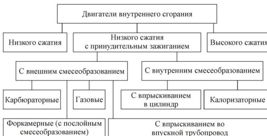
Рис. 1. Общая схема классификации двигателей
