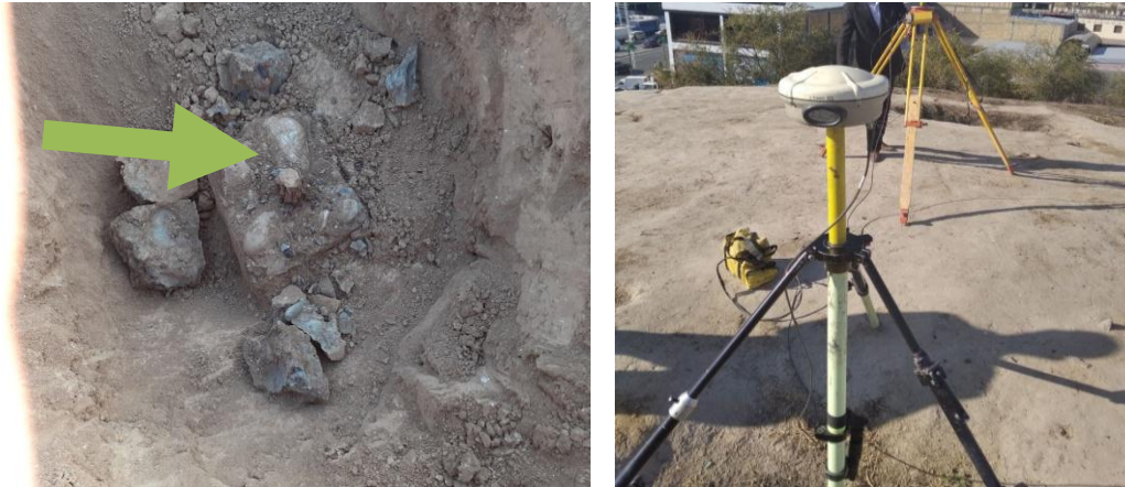
2-rasm. GNSS punktini geodezik o'lchash jarayoni.
