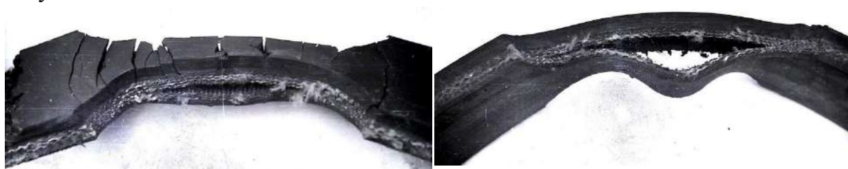
Yuqori sovuq haroratda lentalar mo'rt bo'lib ko'ndalang yoriqlarning hosil bo'lishi
