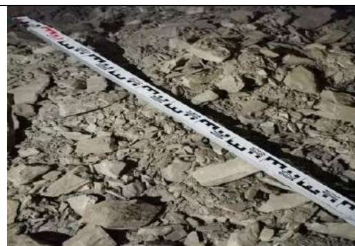
Рис.1.6. Гранулометрический состав взорванной горной массы при применении разработанного паспорта БВР для сечения выработки 10,36 м 2 .
