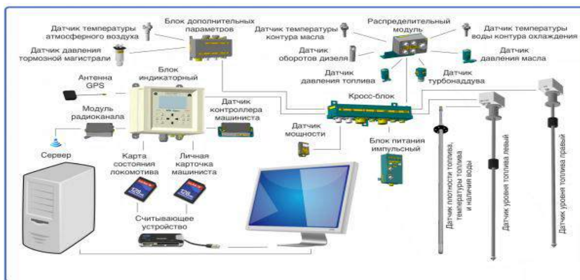
Рис. 5. Алгоритм оценки технического состояния дизель-генераторной установки (ДГУ) тепловозов с применением аппаратно-программного комплекса «Борт»[6].
