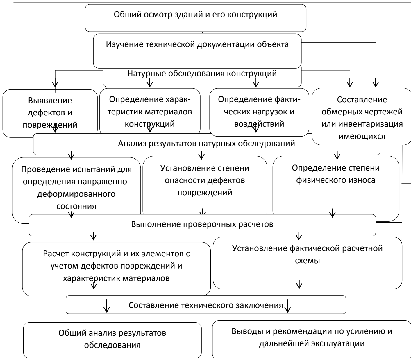
Рис. 2. Последовательность работ по обследованию конструкций зданий.
