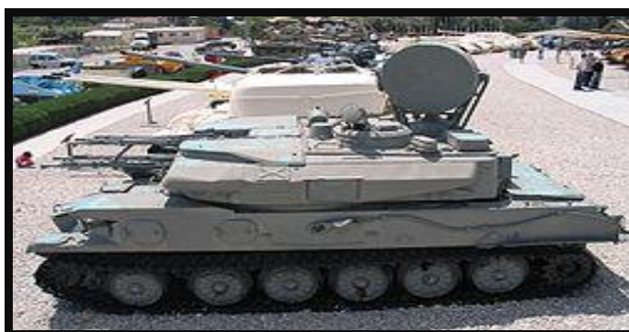
Рис. 5. Антенна РЛС поднята в рабочее положение
